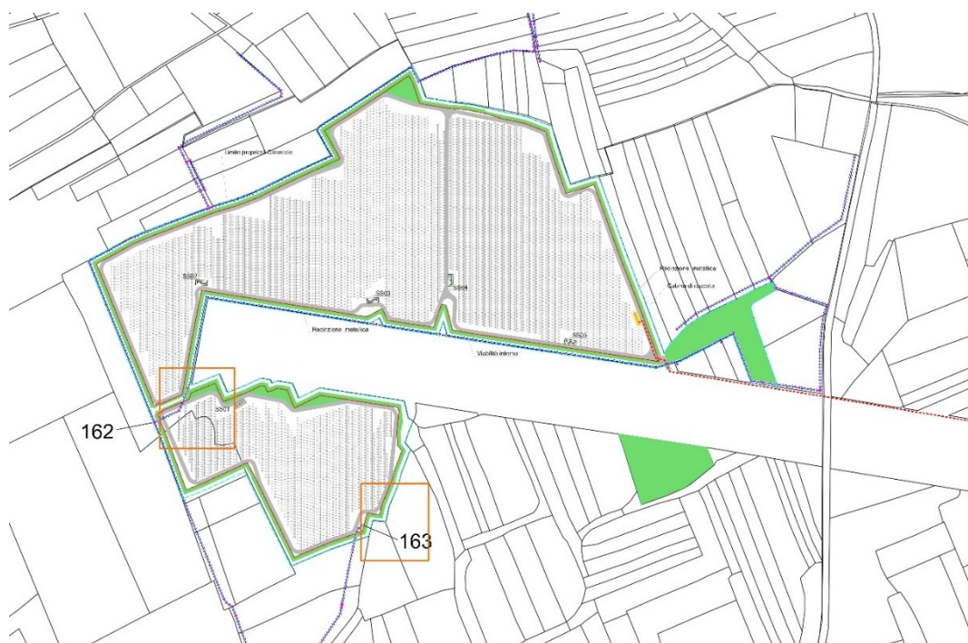
Figura 19 - Posizionamento della rete di tubazioni a 1,5 m dal confine catastale.
